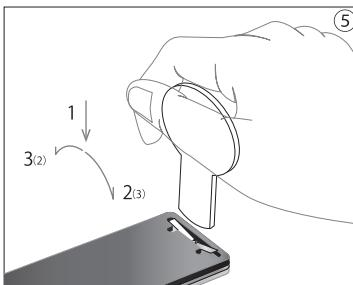
⑤補助器具の先端を足割ピンの根本に押し当ててから前後に倒します。
