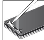
差換えの際は図のように足割ピンを起して抜き、フィルムを差換え、組立手順①へ戻ります。
