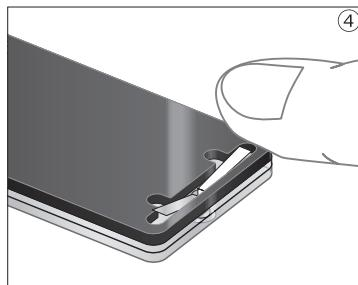
④続けてピンと溝が平行になっていることを確認し、溝に沿って両側を倒していきます。
